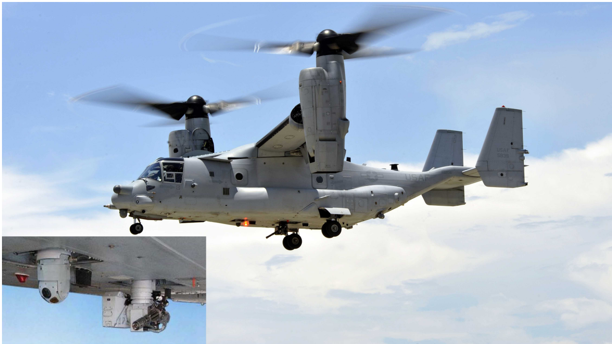
Eine „V-22 Osprey“ mit montierter „GAU-17, 7.62mm mini-gun“ samt Zielvorrichtung.
